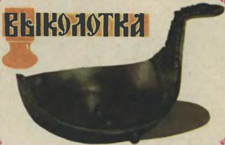
Выколотка (еще ее называют дифовкой) — один из способов холодной обработки металла. Техника выколотки основана на использовании пластичности металла, способного под ударами молотка садиться, вытягиваться и изгибаться. В отличие отковки для выколотки применяется только тонкий листовой металл, который обрабатывается в холодном состоянии. А от чеканки дифовка отличается тем, что вся работа от начала до конца ведется не чеканками, а специальными выколоточными молотками.
